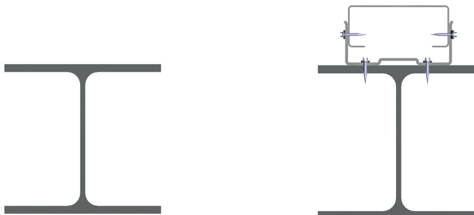
Fig. 21: Stalen constructie en stalen constructie met uit vlakkende achter constructie.
